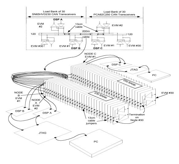
Figure 6. 60-Node CAN Bus
